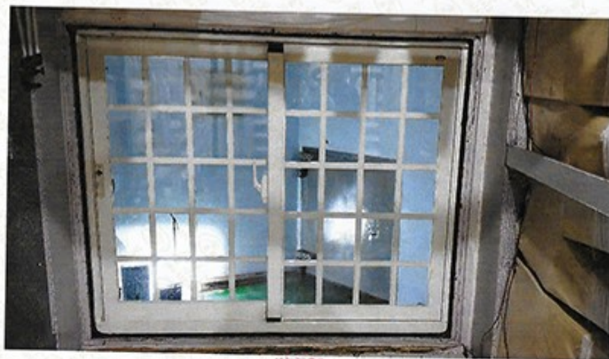
圖 1 試樣佈置圖 (無響室)
